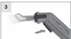
Druk op de schakelaar, de snijpunt wordt verhit en de snijpelk wordt verlicht.
